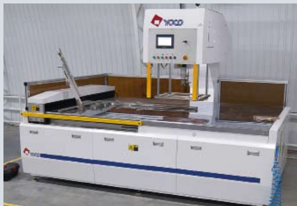
Комплекс оборудования для производства упаковки, поставленный компанией «Терра Системы»: фальцевально-склеивающая машина Apollo 65 FC, вырубной пресс Nikko JY-76, устройство для удаления обля и разделения заготовок Yoco SM-1080, флаторезальное оборудование для нарезки рулонного материала на листы Maxcut 1400
