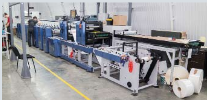
В «Печатном Доме Пенза» организован цех флексографской печати для производства самоклеящейся этикетки
