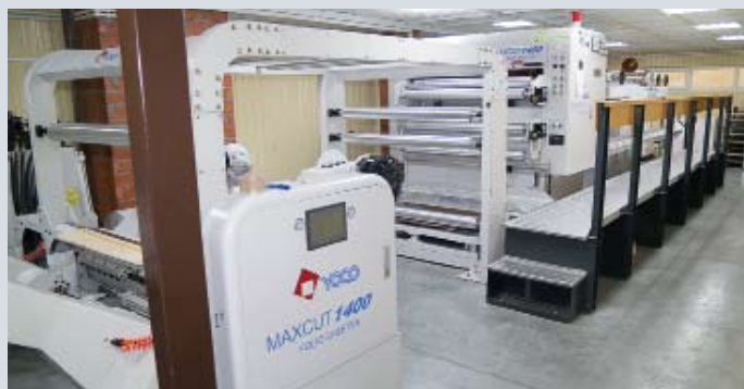
Комплекс оборудования для производства упаковки, поставленный компанией «Терра Системы»: фальцевально-склеивающая машина Apollo 65 FC, вырубной пресс Nikko JY-76, устройство для удаления обля и разделения заготовок Yoco SM-1080, флаторезальное оборудование для нарезки рулонного материала на листы Maxcut 1400
