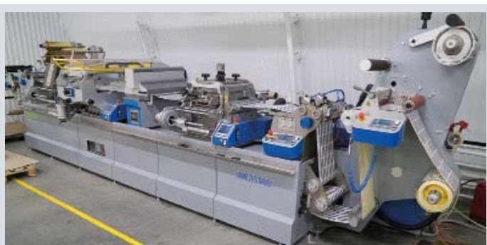
Линия Cartes GT360 Custom для послепечатной отделки этикетки, выполняющая горячее тиснение, конгрев и трафаретную печать
